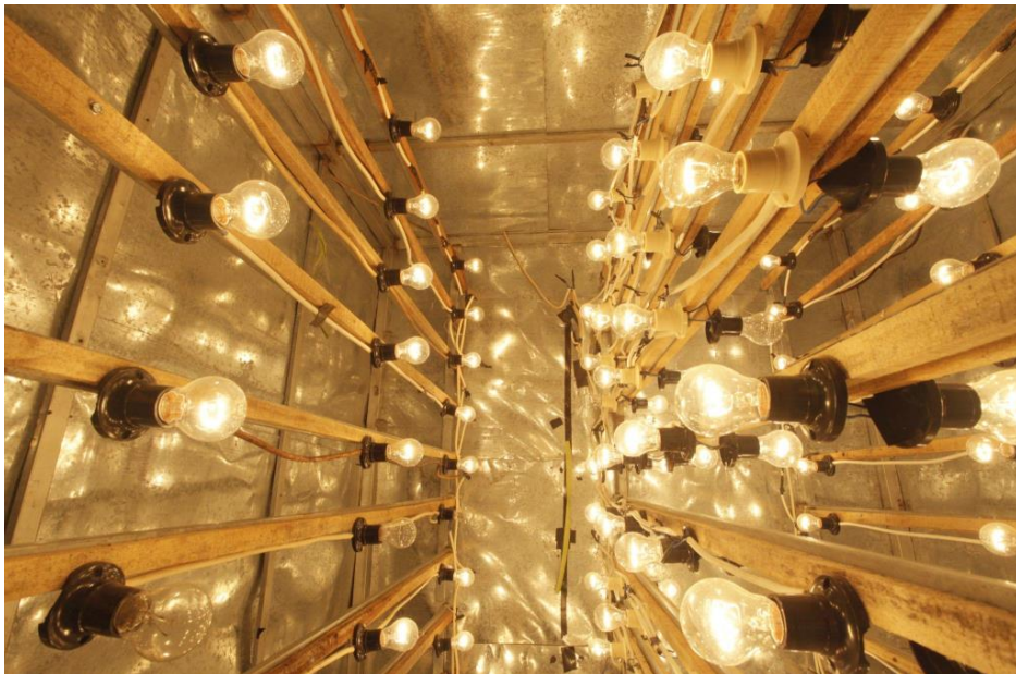
Gambar 4.4. Oven untuk mengeringkan adonan kerupuk saat musim penghujan (menggantikan proses menjemur di bawah sinar matahari)
